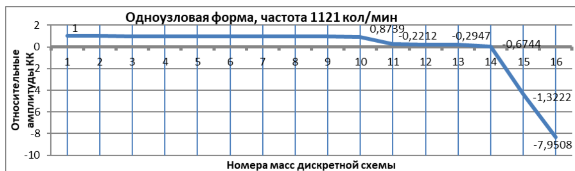
Рисунок 3 – Одноузловая форма свободных крутильных колебаний валопровода МДК судна при установке промежуточного вала из ПКМ
