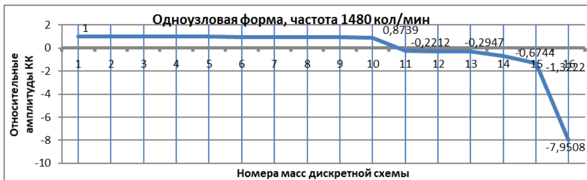
Рисунок 2 – Одноузловая форма свободных крутильных колебаний валопровода МДК судна
