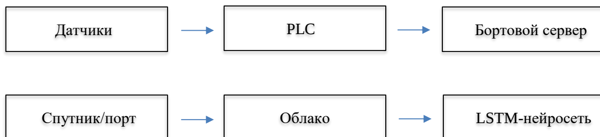
Рисунок 1 – Архитектура сбора и передачи данных для прогнозирования остаточного ресурса судового дизеля
