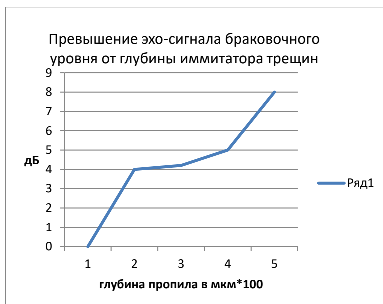
Рисунок 3 – Ультразвуковой контроль наплавов в КО с предельной чувствительностью 100 мкм
