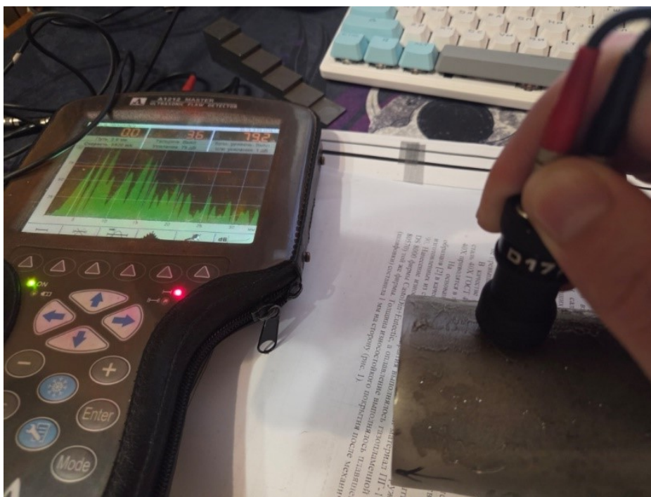
Рисунок 2 – Определение уровня эхо-сигнала от имитатора трещины (пропила)
