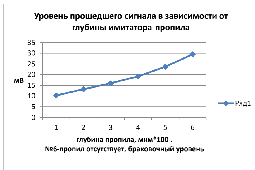
Рисунок 6 – Зависимость уровня прошедшего сигнала от глубины имитатор трещины
