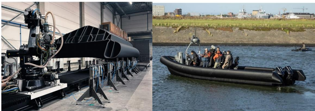
Рисунок 2 –Процесс печати корпуса судна (слева), испытание получившегося автономного судна на базе НАТО (справа)
