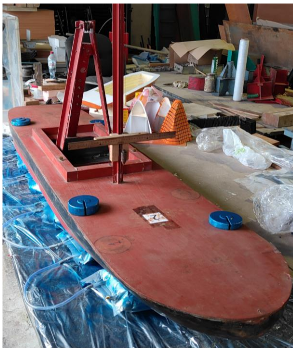
Рисунок 2 – Модель судна на накачанных воздухом поперечных оболочках
