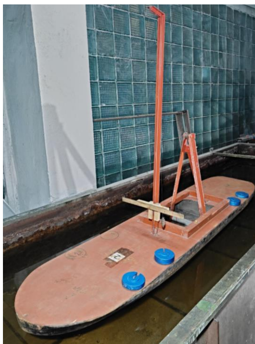
Рисунок 1 – Лабораторная установка для опыта кренования модели судна на воде
