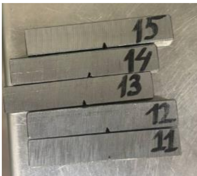
Рисунок 2 – Образцы для испытаний на ударный изгиб
