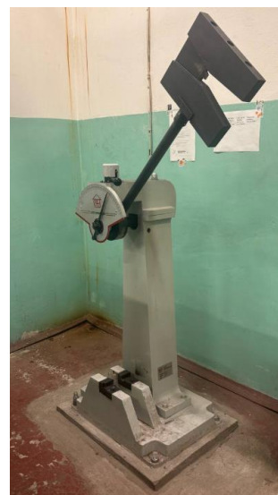
Рисунок 3 - Схема испытания образцов на ударную вязкость: 1 - маятник копра; 2 – нож маятника; 3 – опоры; 4 – образец
