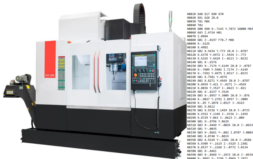
Рисунок 3 – Вертикальные обрабатывающие центры KMT KVL 650 и программа
