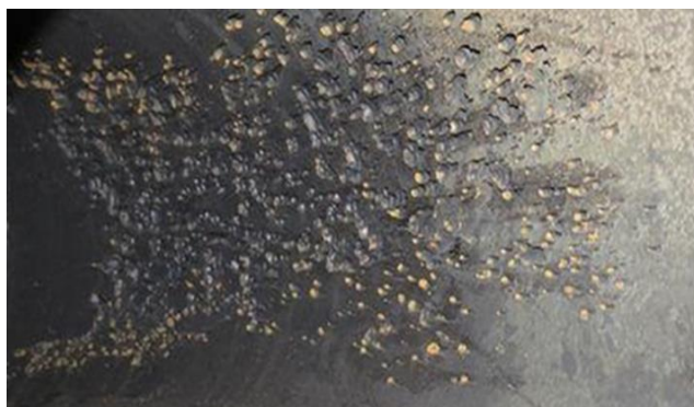
Рисунок 1 – Кавитационная эрозия поверхности
